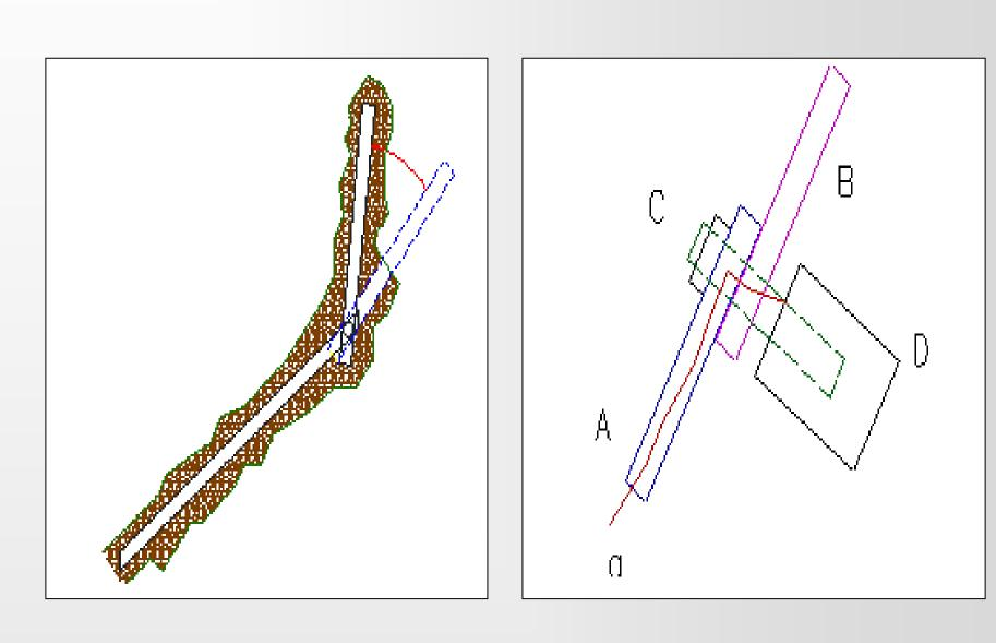
Entre las dos barras que aparecen en la figura de la derecha se coloca una dinamo, cuando se mueve por efecto del viento hace que la dinamo gire produciendo electricidad. La cantidad de energía generada es independiente de la dirección del viento.
